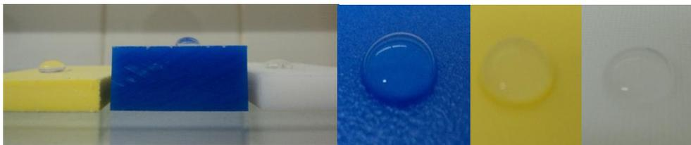
Bild 6: Kunststoffproben mit unbehandelter Oberfläche sofort nach dem Kontakt mit einer Flüssigkeit
