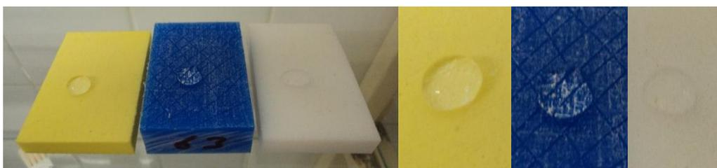
Bild 8: Kunststoffproben mit behandelter Oberfläche sofort nach dem Kontakt mit einer Flüssigkeit
