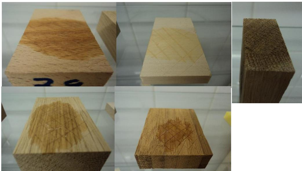
Bild 7: Holzproben mit behandelter Oberfläche sofort nach dem Kontakt mit einer Flüssigkeit
