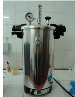
Abbildung 14: Autoklav zur Vernichtung der der Nährbodenträger
