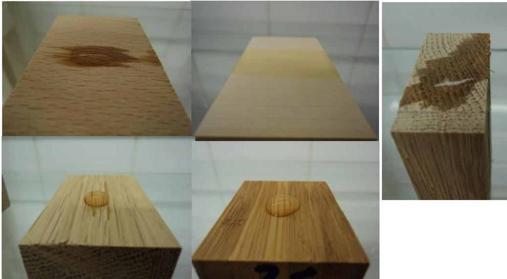
Bild 5: Holzproben mit unbehandelter Oberfläche sofort nach dem Kontakt mit einer Flüssigkeit
